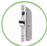
Beim Schließen der Tür fahren die Fallenriegel um 20 mm in die Schließbleiste und verriegeln so die Tür mehrfach - ohne Schlüssel!
